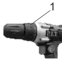
Проверьте правильность установки переключателя крутящего момента шпинделья(1). При использовании инструмента как шуруповерт, установите одну из цифр «1, 2, 3...18» на переключателе или
